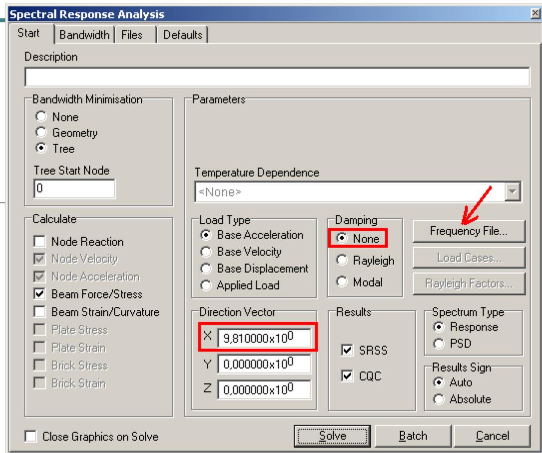
Si setta Damping (smorzamento) su None e si introduce il moltiplicatore di  $S_d$  nelle tre direzioni.
