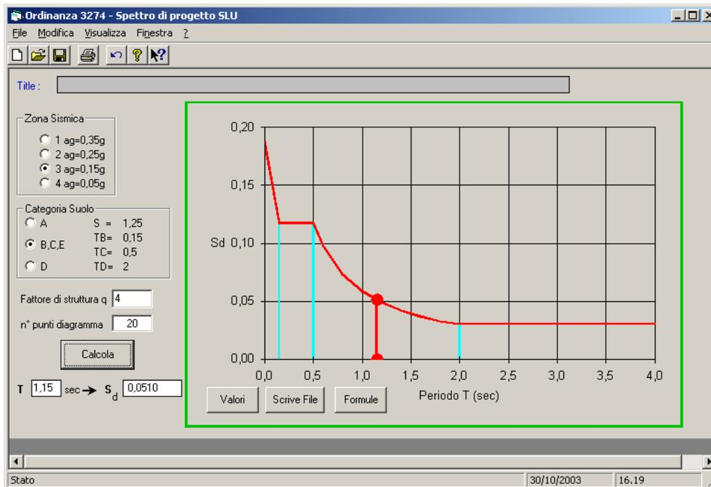
Fig. 1 – Spettro di progetto secondo Ordinanza 3274 del 20.3.2003
