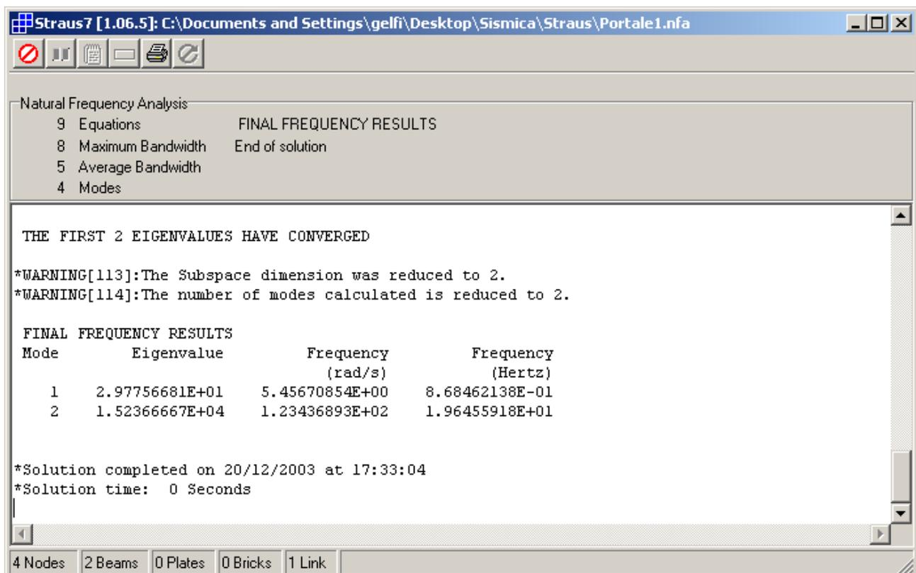
Il valore della frequenza del primo modo (5,456 rad/s) coincide col valore del calcolo manuale (5,46).
