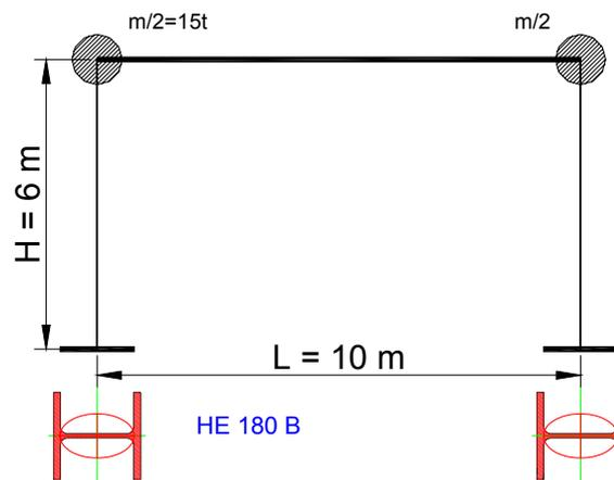
Il portale di figura si ripete ogni 6 m e porta un impalcato con carico, comprensivo di peso proprio, di  $5 \text{ kN/m}^2$ . La trave è quindi soggetta al carico distribuito  $q=6 \cdot 5=30 \text{ kN/m}$ , di risultante  $Q=300 \text{ kN}$ . La massa è quindi  $M=300/9,81 \approx 30 \text{ t}$ . Si consideri la trave infinitamente rigida. Le colonne hanno lunghezza di libera inflessione  $L_0=H$ . Si adotti un profilo HE 180 B.
