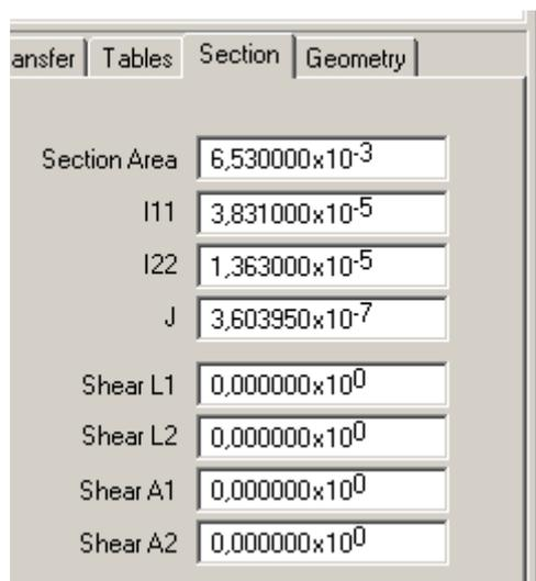
Porre Shear A1 e A2=0 per non considerare la deformabilità a taglio ed ottenere gli stessi risultati del calcolo manuale.
